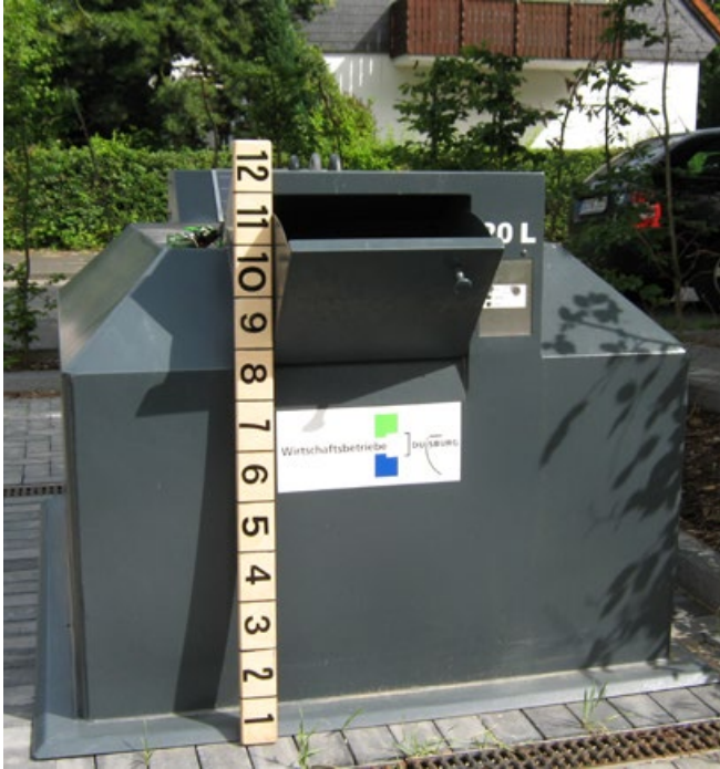
Halbunterflurbehälter in Duisburg; Quelle: Wirtschaftsbetriebe Duisburg
