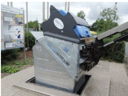
Unterflurssystem für Seitenlader (oben) und Großbehälter mit Kammleisten-Aufnahme (unten); Quelle: Dosta Subwave
