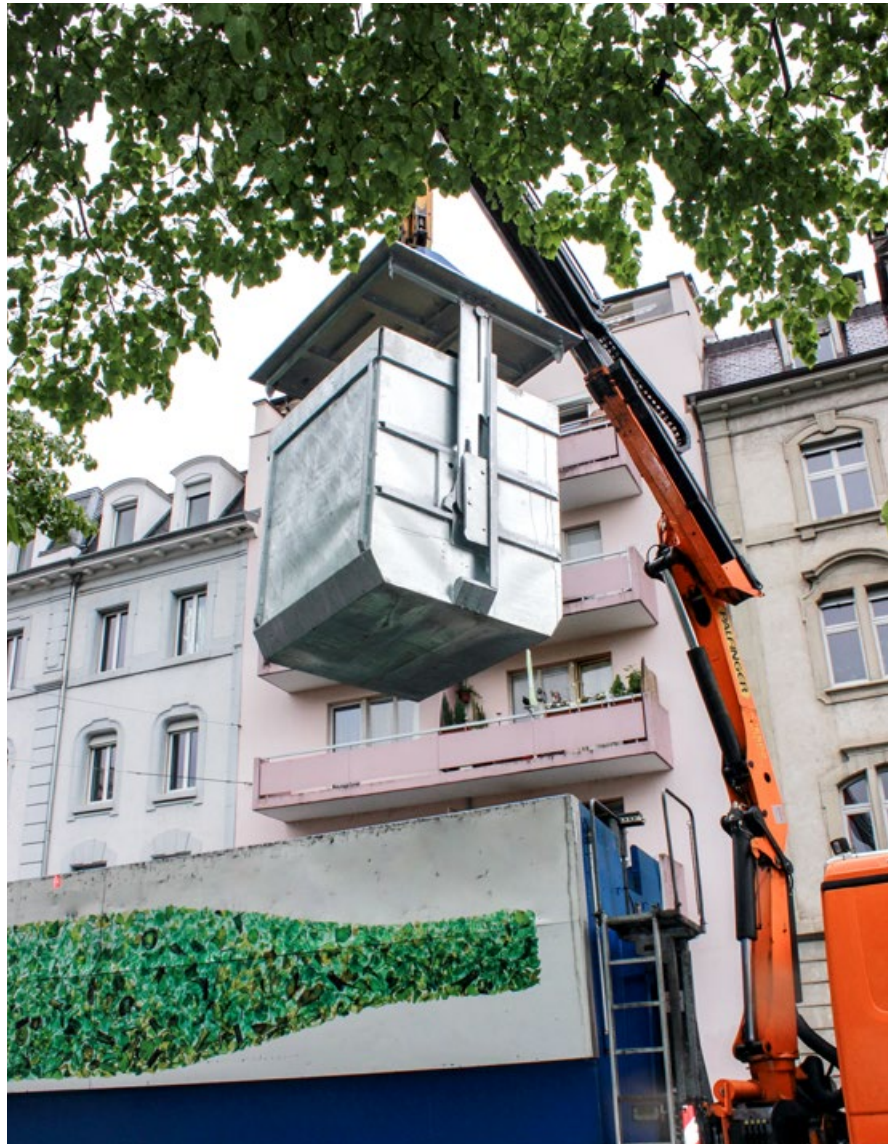
Unterflurbehälter mit Kippmechanismus (rechts); Quelle: Stadtreinigung Hamburg (SRHH)
