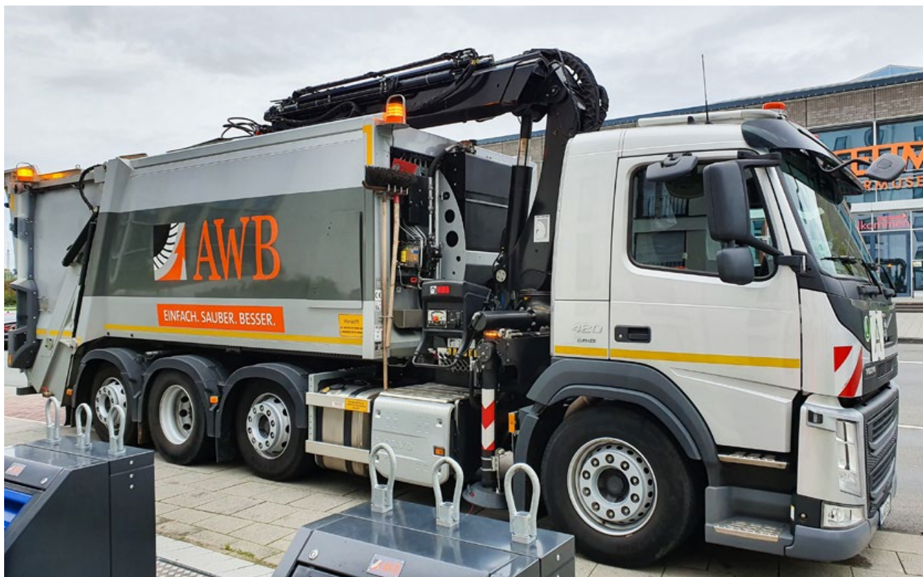
Kranmüllfahrzeug 4-Achser, wie es in Köln genutzt wird; Quelle: AWB Köln GmbH
