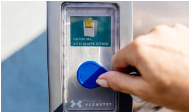
Elektronische Zugangsbeschränkung; Quelle: Wirtschaftsbetriebe Duisburg
