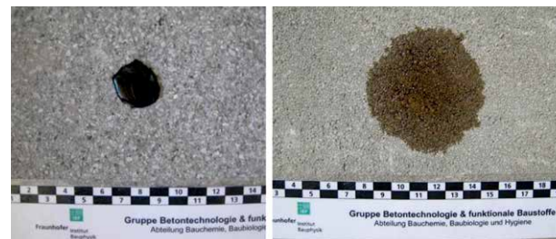
Ölfleck auf Pflasterstein mit geschliffener, gestrahter und beschichteter Oberfläche (links) und betonglatte Oberfläche (rechts) etwa zehn Minuten nach dem Auftropfen.
