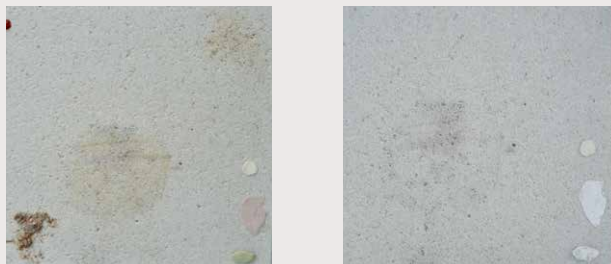
Vergleich beschichteter Steine einen Tag nach der Verschmutzung (links) und nach einem Monat Witterungseinfluss (rechts)
